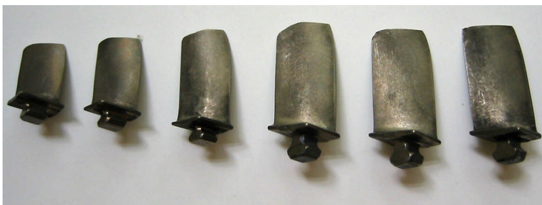
Рис. 44. Газоабразивный износ лопаток компрессора вертолётной силовой установки ТВ3-117
