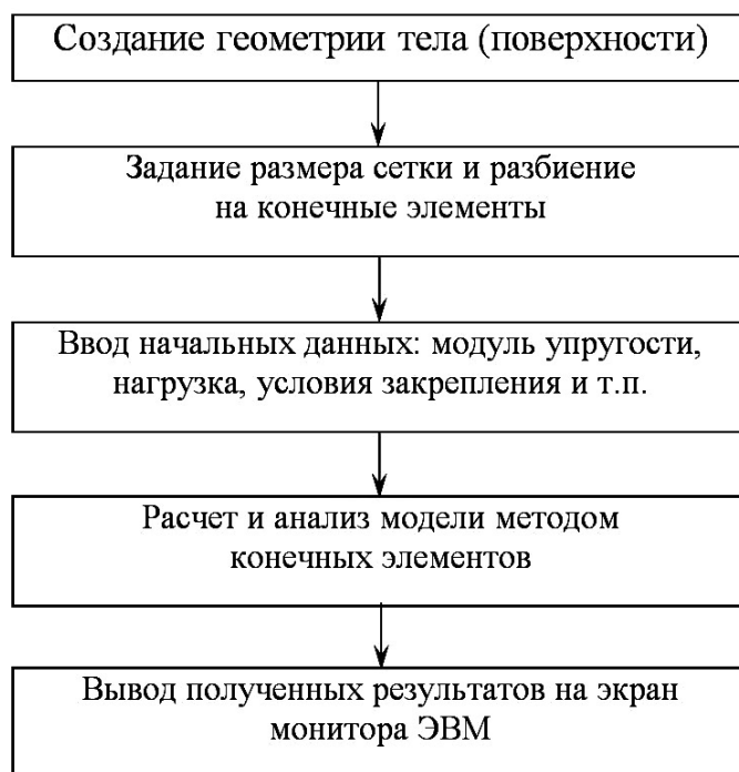
Рис. 113. Схема проведения исследования напряжённо-деформированного состояния с помощью метода конечно-элементного анализа
