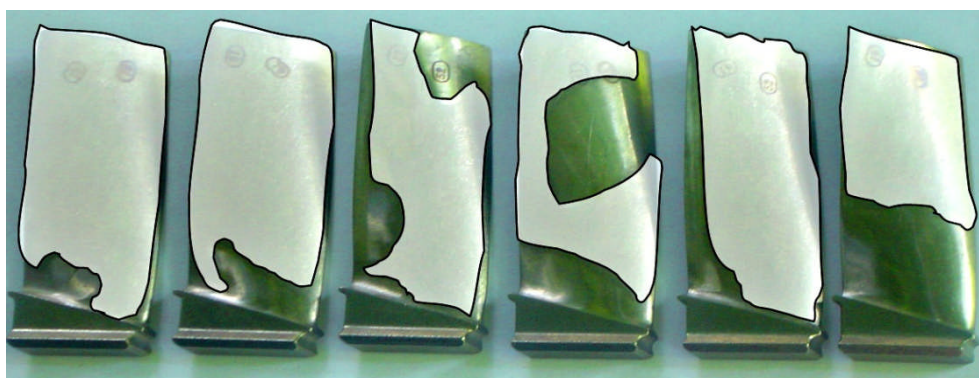
Рис. 47. Характер износа лопаток компрессора по их длине (выделена площадь поверхности лопатки, поврежденная абразивными частицами)
