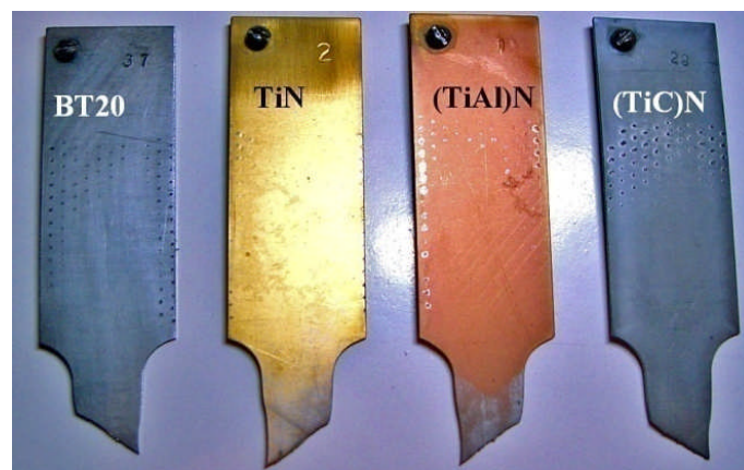
Рис. 110. Характер разрушения образцов с покрытиями
