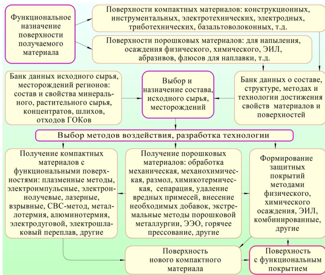
Рис. 14. Методологическая схема создания поверхности с функциональным покрытием методом ЭИЛ в условиях нового этапа развития науки о материалах – материаловедения поверхности
