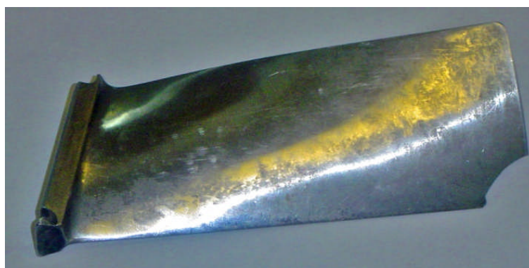
Рис. 50. Обрыв кромки пера лопатки компрессора
