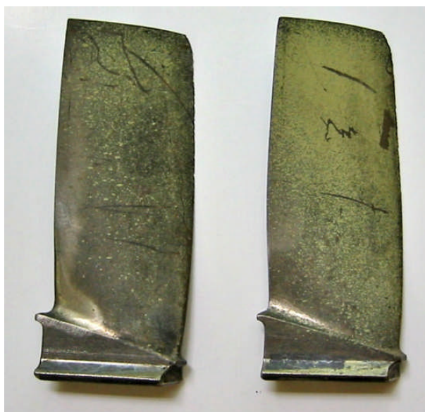
Рис. 51. Налипание грязи на лопатки компрессора силовой установки ТВЗ-117
