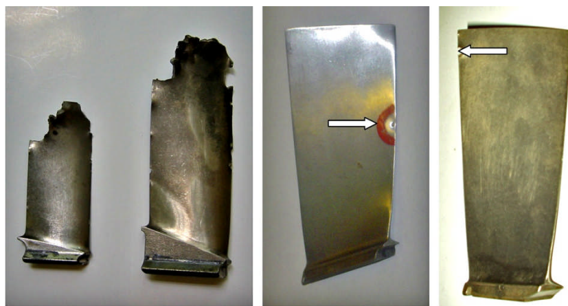
Рис. 48. Разрушение и забоины на лопатках компрессора от попадания посторонних предметов
