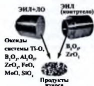
Рис. 5.38. Схема формирования фазового состава продуктов фреттинг-изнашивания в паре трения «комбинированное покрытие – электроискровое покрытие»
