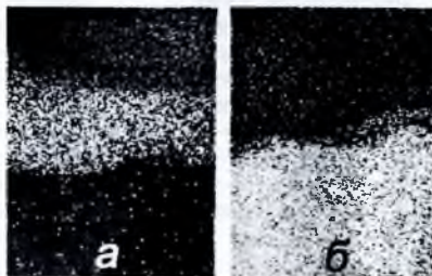
Рис. 3.40. Микрофотография поверхности титан-платинового бианода в характеристических рентгеновых лучах: а) Pt_{L\alpha} ; б) Ti_{K\alpha}
