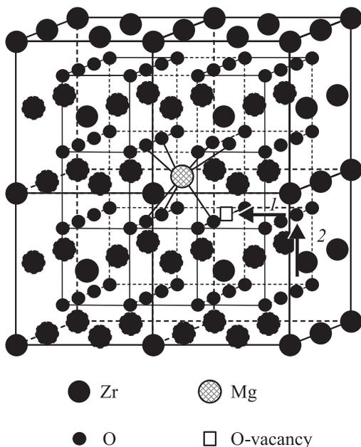
**Рис. 1.** Схема расположения атомов в кубическом диоксиде циркония при стабилизации его 3.125 mol.% MgO. Стрелками показаны процессы движения ионов кислорода при образовании активной вакансии (1) и миграции, ответственной за электрическую проводимость (2).
