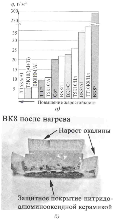
Рис. 3. Удельный прирост массы модельных материалов q TiC*, Co*, BK8* (без покрытия) и ВТС с ЭИЛ-покрытиями (а); образец ВК8 ( \times 14 ) с покрытием нижней стороны Al-электродом после окисления (б)
