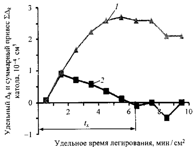
Рис. 2. Зависимости удельного (1) и суммарного (2) привесов катода от времени легирования
